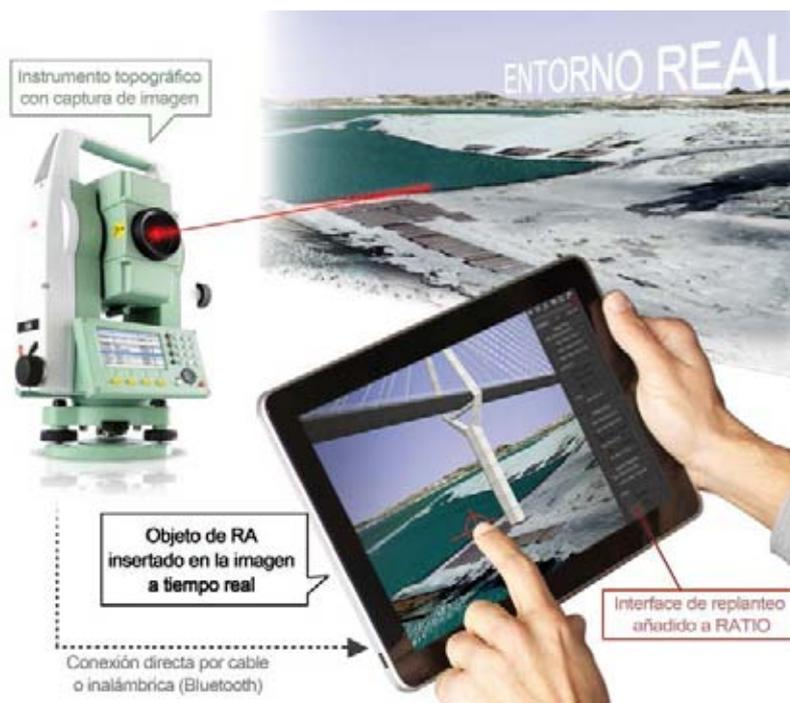
Esquema básico de funcionamiento del sistema RATIO.
